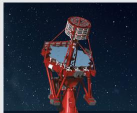
SST-1M (oben): Ein-Spiegel-Konstruktion mit einer SiPM Kamera, die Struktur ist eine kleinere Version der MST-Struktur.
