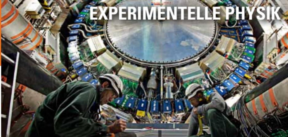
dem Spurdetektor kann man die vielen, eng benachbarten Spuren geladener Teilchen trennen, und mit einer Genauigkeit von besser als 0,01 Millimetern vermessen.
